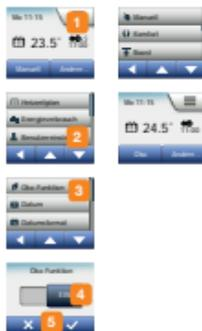
Bei ermöglichter Öko-Funktion ändert sich der Planmäßiger-Betrieb-Startbildschirm. Die untere linke Taste wechselt von „**Manuell**“ auf „**Öko**“.
