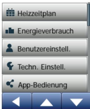
Mit diesen Einstellungen können Sie den Thermostat für die Verbindung mit einem Drahtlosnetzwerk einrichten, über das sich der Thermostat mit unserem Thermostat-Cloudserver verbinden kann. Mithilfe der Serververbindung können Sie den Thermostat mit der App SWATT® (Smart Wifi And Touch Thermostat) von einem Smartphone oder Tablet mit Internetanschluss fernsteuern.
