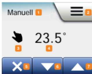
Mit der manuellen Übersteuerung können Sie den planmäßigen Betrieb deaktivieren und eine vorzugebende Temperatur rund um die Uhr aufrecht erhalten.
