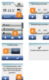
Mit dem Urlaubsmodus lässt sich die Heizung in Ihrem Haus während Ihrer Abwesenheit auf minimalen Betrieb einstellen, und spart damit Energie und Geld. Abreise- und Rückkehrdatum sind von Ihnen einzustellen. Der Thermostat sichert, dass die Fußbodentemperatur über dem Gefrierpunkt gehalten wird, und Ihr Haus bei der Rückkehr wieder geheizt ist. Dazu sind nur wenige Schritte erforderlich:
