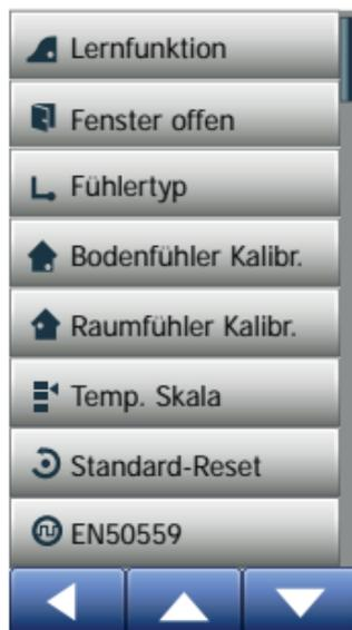
Dieses Menü enthält alle Parameter, die vom Techniker bei der Thermostatinstallation oder -wartung eingestellt werden müssen. Das Menü umfasst folgende Optionen:
