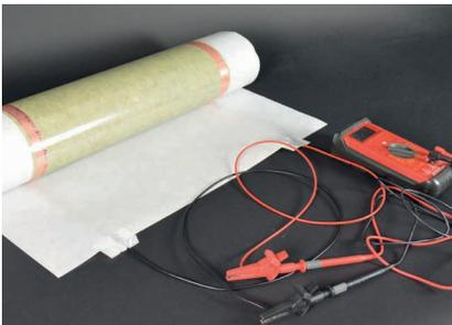
Widerstand gemäß Montageanleitung & Bedienungsanleitung überprüfen und Werte im Prüfprotokoll dokumentieren.
